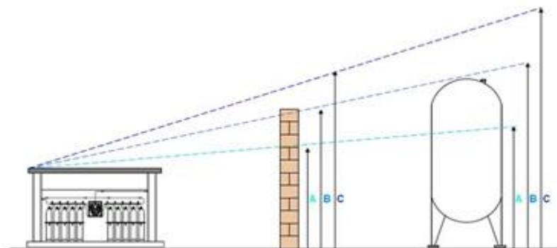
Figura 1 : Esempio di parete divisoria di protezione del serbatoio criogenico (dimensionamento a cura di tecnico specializzato)
