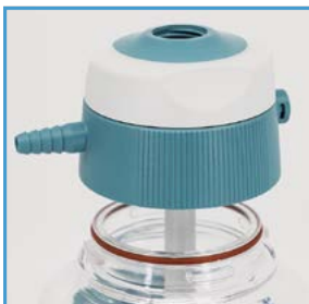
ACCOPPIAMENTO BICCHIERE - COPERCHIO CON AGGANCIAMENTO RAPIDO 1/12 DI GIRO
